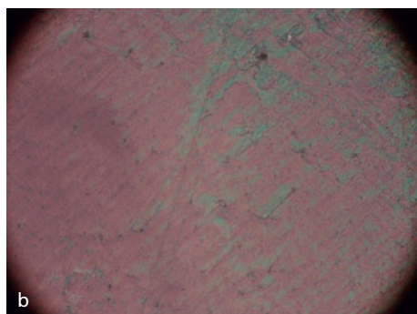
Abb. 1 Polarisationsmikroskopische Aufnahmen eines orientierten Reaktivmesogens; a) Reibrichtung der Orientierungsschicht parallel zum Polarisator; b) Reibrichtung 45° zum Polarisator
