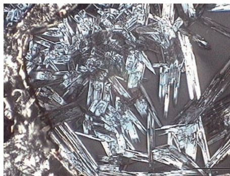
Abb. 3 Lichtmikroskopische Aufnahme bei gekreuzten Polarisatoren einer 30%igen CC-Lösung
